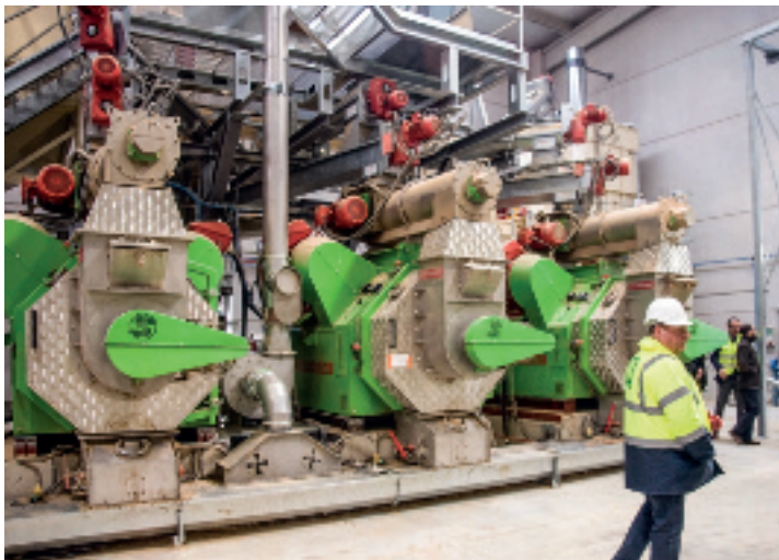
Tres granuladoras Salmatec, suministradas por R&B, se encargarán de producir hasta 140.000 t/año de pellets de madera y de paja
