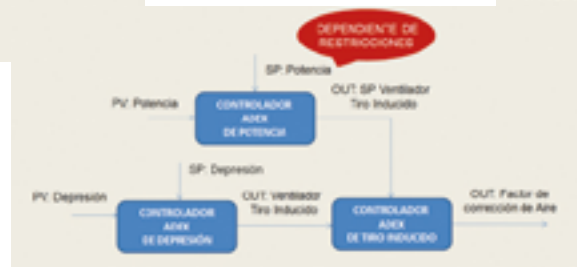
Figura 4: Control optimizado del aire aportado a la caldera
