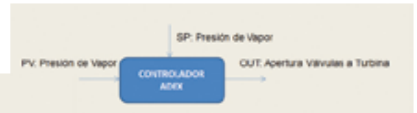
Figura 3: Control auxiliar de la presión
