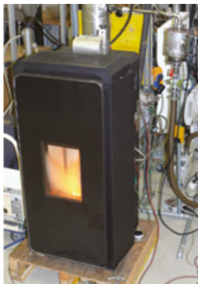
Figura 2: Prototipo de la estufa de pellets con la nueva tecnología de microgeneración con TEG en el banco de pruebas de BIOS
