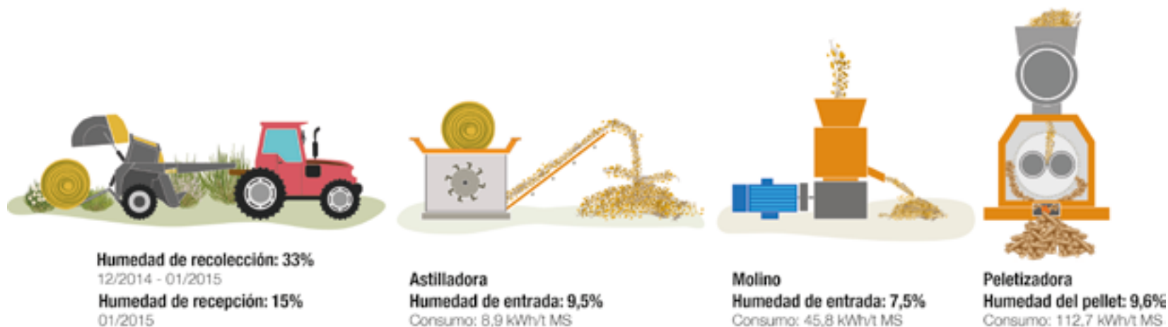
Proceso de preparación de escoba recolectada en Las Navas del Marqués para obtener pellets
