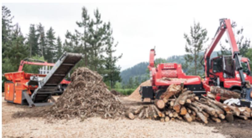
En el stand de Mycsa, varios equipos para el procesamiento de la biomasa forestal, como la trituradora de doble eje Arjes VZ 750 y la astilladora Eschböck Biber 84, pensada procesar gran cantidad de ramaje y troncos de 60 cm gracias a una boca de alimentación de 122 cm.
