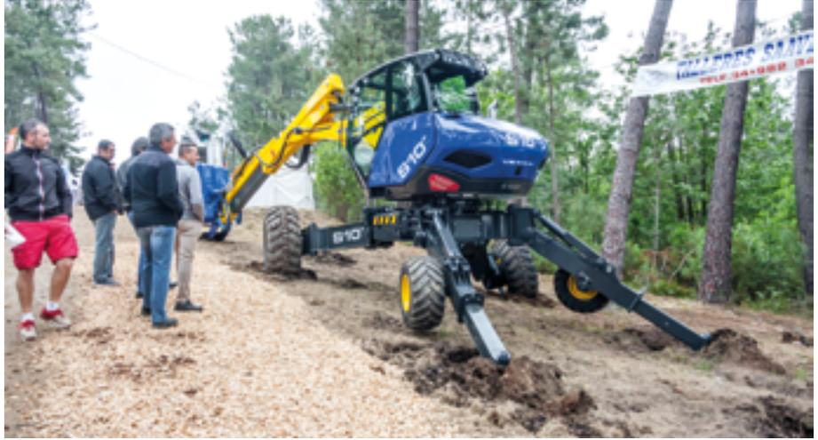
Talleres Saavedra es el representante oficial de la retro-araña Kaiser. Es una máquina excavadora con capacidad de giro de 360° montada en un chasis con 4 patas con movilidad independiente (vertical y horizontal). Además, posee un brazo telescópico que admite diferentes cabezales de trabajo. [www.talleressaavedra.es](http://www.talleressaavedra.es)
