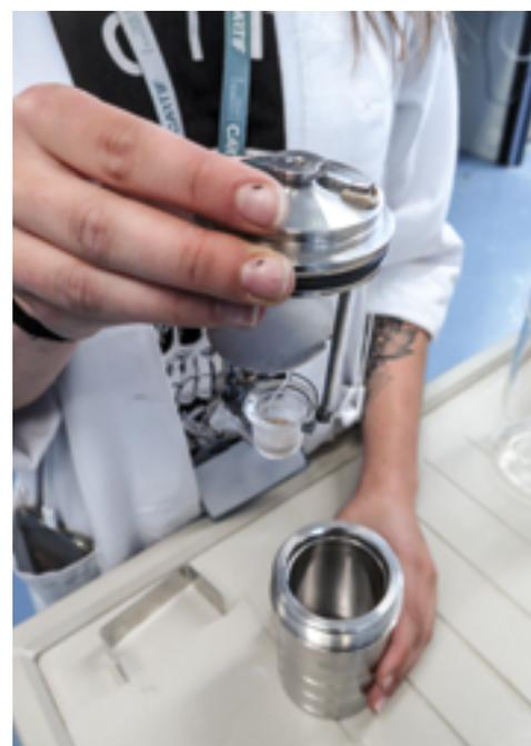
Preparación de muestra para calcular el poder calorífico
