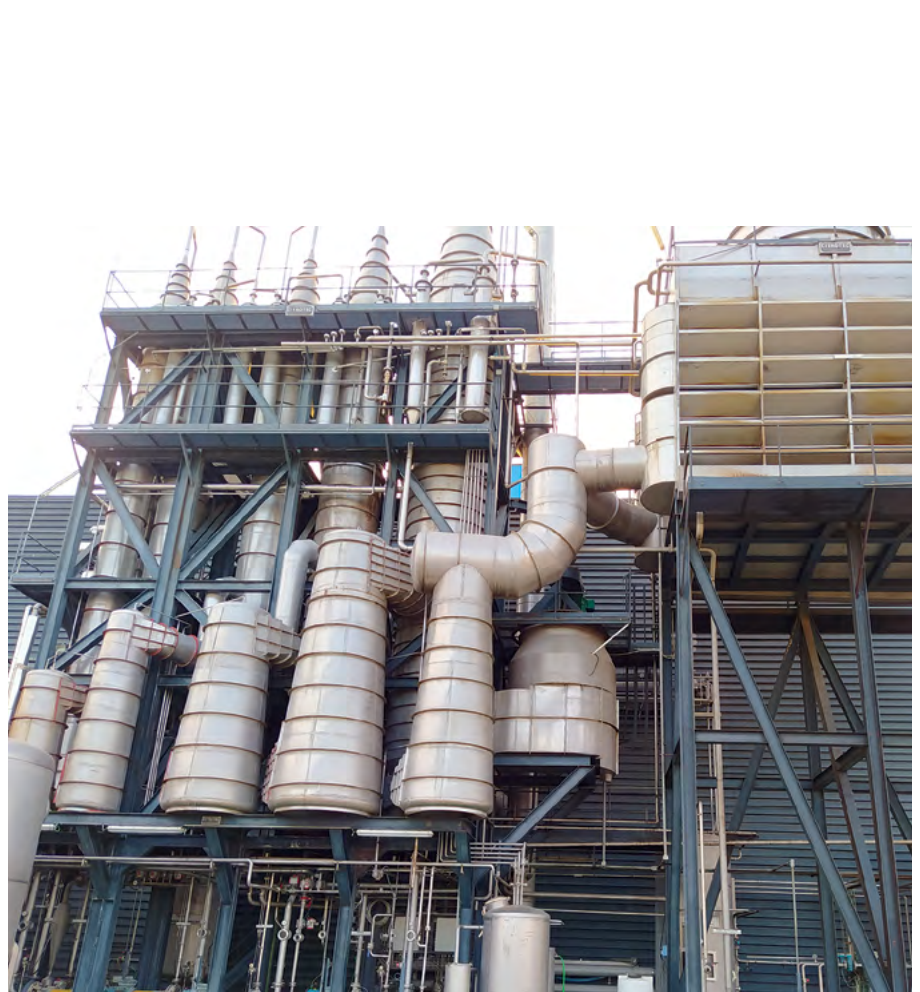
Concentradores licor de prensado. Parte del proceso de secado de la piel de las naranjas con bioenergía
